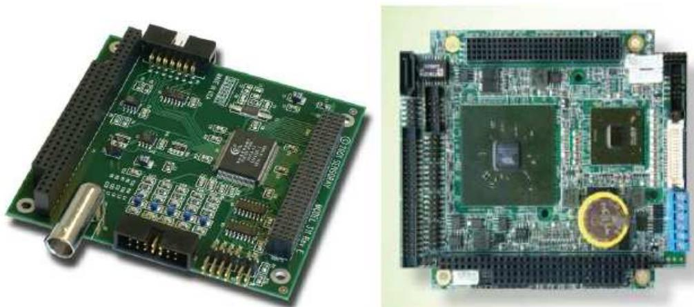
Figura 3, Framegrabber Sensoray 311 (izq.) y CPU Azure Mars 700 (der)
