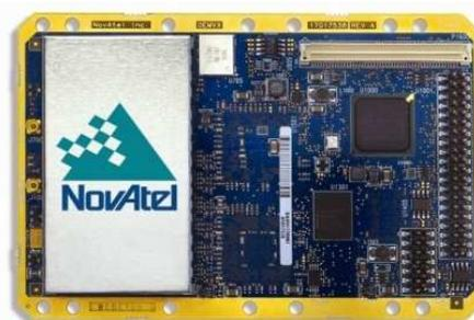
Figura 5, Receptor GPS de grado geodésico Novatel OEMV-3
