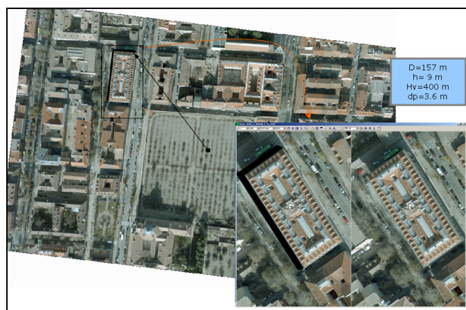
Figura 6: Efecto real de oclusión sobre la ortofoto convencional mediante la rectificación de un edificio. Vuelo realizado con UltraCamD, GSD: 4cm
