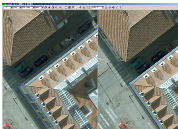
Figura 1: Detalle de Orto-Rectificación Verdadera en un edificio de Aranjuez. Vuelo realizado con UltraCamD, GSD: 4cm
