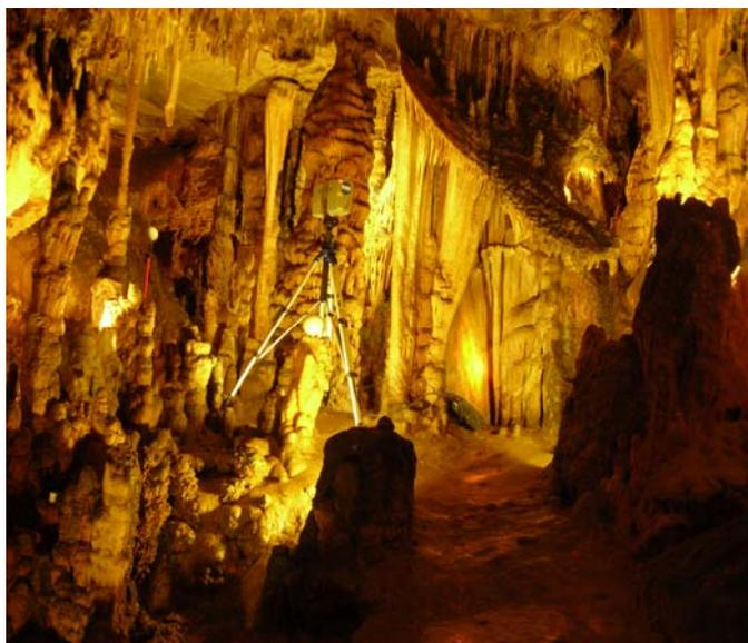
Figura 3: Detalle de láser escáner 3D trabajando en el interior de la cavidad.
