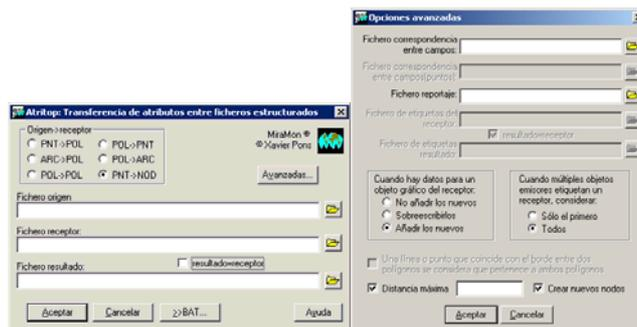
Figura 4. Vista de la opción PNT → NOD del módulo AtriTop. En las opciones Avanzadas puede especificarse una distancia máxima y la opción de crear nuevos nodos.
